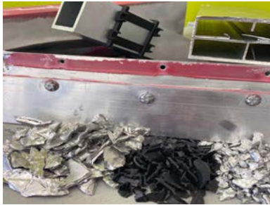
Demontage, Zerkleinerung und Sortierung von Multi-Material-Verbunden
