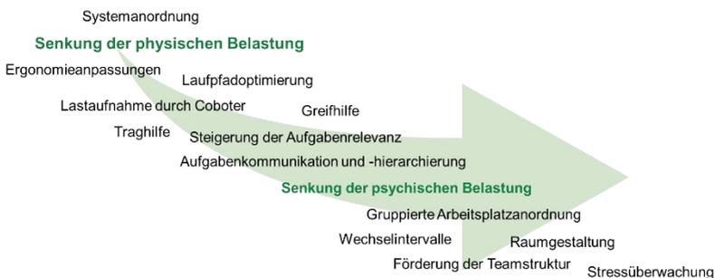
*Abbildung 9: Handlungsempfehlungen zur Entlastung des Werkers am Beispiel des cobotergestützten Hybridfügeprozesses eines Batteriekastenprofils mit einem Deckblech*
