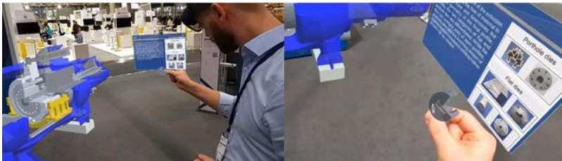
Abbildung 6: Live-Kollaboration zwischen mehreren AR-Devices ermöglicht gemeinschaftliches Lernen. Aktionen von Person A (rechts) werden in Echtzeit für Person B (links) sichtbar und umgekehrt. Ein Video zur dargestellten Szene findet sich unter Link .
