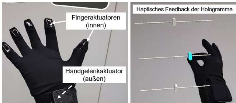
Abbildung 7: Mit Hilfe leichter und mobiler Haptik-Handschuhe (links) können AR-Hologramme ertastbar gemacht werden (rechts), indem jede virtuelle Interaktion über Aktuatoren ein haptisches Feedback erzeugt.
