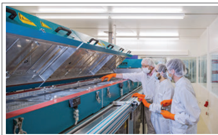
Trockenstrecke der Forschungsproduktionslinie für Lithium-Ionen-Zellen am iwB (Foto: iwB)
