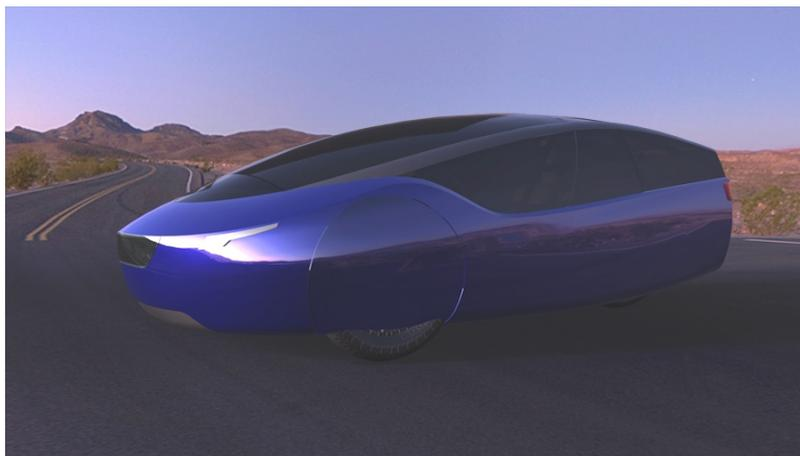
**Abbildung 2.14:** Projekt *URBEE* (Urban electric vehicle with ethanol as backup), Hybrid-Fahrzeug in Integral- und Leichtbauweise mittels additiver Fertigung (Bildmaterial zur Verfügung gestellt durch Kor EcoLogic Inc.)
