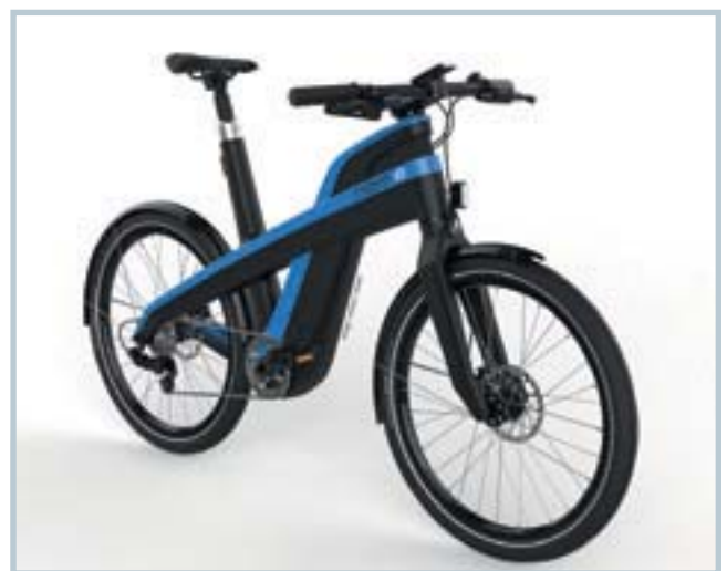
Bild 8. Prototyp des Elektrofahrads „nam:e“ aus dem Projekt Ther-Mobility: In der teilweise endlosfaserverstärkten Struktur des Rahmens verschwinden Elektromotor und Akku aus dem Sichtfeld (© newkon)
