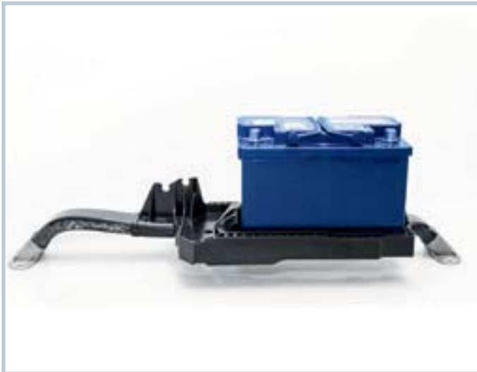
Bild 6. Hybrider Batterieträger: Beim Anspritzen funktioneller Elemente geht es darum, das Kollabieren des textilverstärkten Hohlkörpers während des Spritzgießvorgangs zu verhindern (© ILK/TU Dresden)
