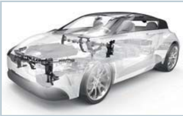
Bild 5. IHU-Komponenten im Fahrzeug: Frontendträger und Cockpitquerträger sind als Metall-Kunststoff-Verbunde ausgeführt
