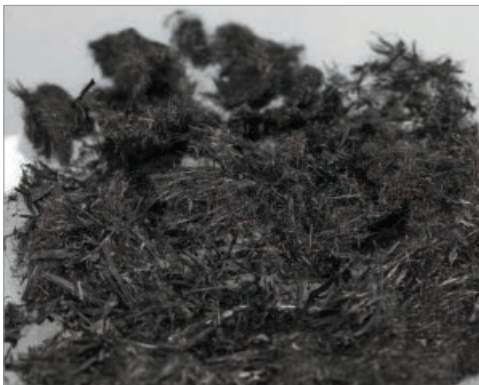
Faserfraktionen, die mit Hilfe der Schockwellentechnologie freigelegt wurden.
