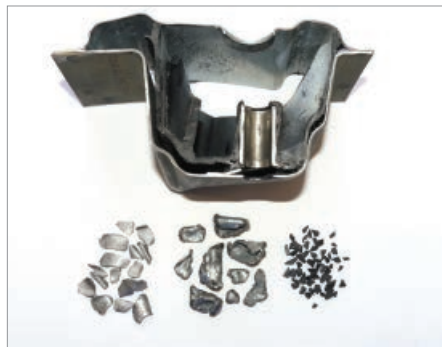
Querschnitt durch eine hybride Leichtbaukomponente und deren Einzelkomponenten als Recyclingware. Foto: IAM/TU Bergakademie Freiberg
