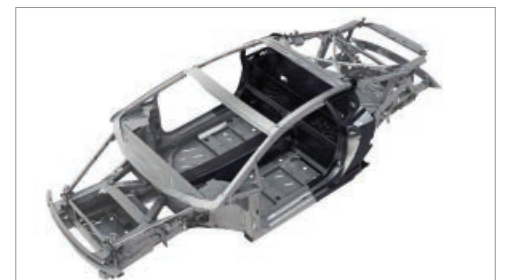
Durch die Kombination von FKV mit Metallen ergeben sich im Karosseriebau erhebliche Gewichtseinsparungen.
